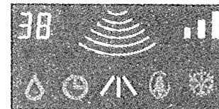
② 運転を開始してから、操作パネルの「TIMER」ボタンを押すとタイマー機能を設定します。一回押すと1時間プラス設定します。
